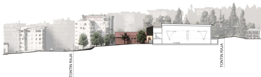
Kuva 4 Poikkileikkaus hallista osoittaa hallin korkeuden nykyiseen maanpintaan nähden. Hallin eteläreuna myötäilee maanpinnan nykyistä korkotasoa. Asemakaavassa on annettu rakennuksen ja rakenteiden ylin korkeusasema, jota ei tule ylittää. Niemen navetan tornit, sekä Tuomas Antinpojan puiston puusto jäävät hallia korkeammiksi. Kuva: Arkkitehdit Kontukoski Oy.
