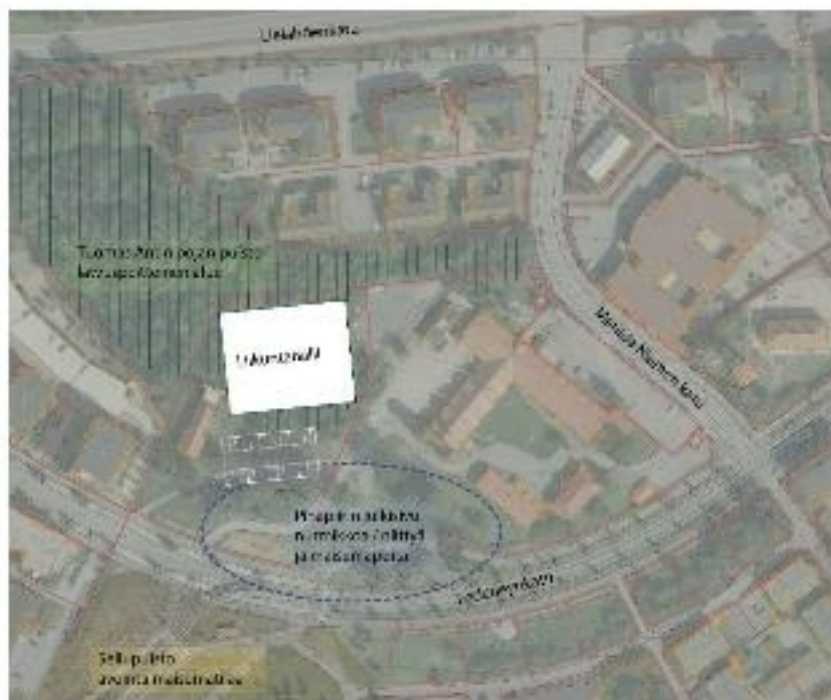
Kuva 10 Asemakaavaehdotuksen mukainen ratkaisu. Asemapiirustuksessa noin 2400 k-m2 kokoinen halli sijoitettuna tontin pohjoisosaan. Pysäköinti sijoittuisi tontin keskivaiheille rinteiden korkeuskäyriä myötäillen. Ratkaisu haastaa Tuomas Antinpuiston puiston olosuhteita vaihtoehtoista eniten, mutta mahdollistaa Niemen kartanon etelään avautuvan pihapiirin piirteiden ja puuston säilymistä.
